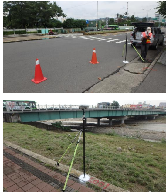
圖 5 VBS-RTK 控制測量作業示意圖
