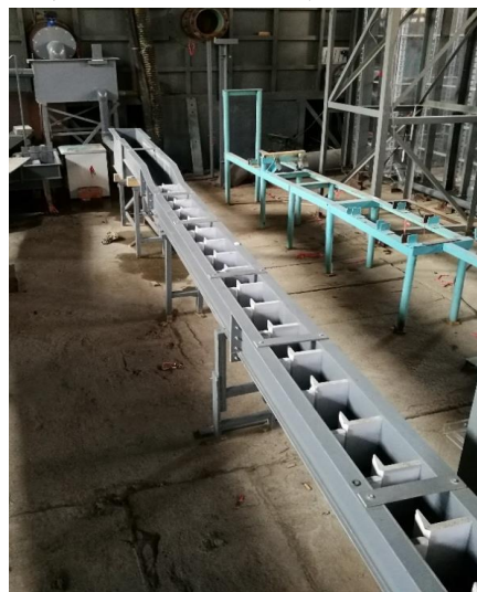
图13 霍口升鱼机集鱼平台局部物理模型试验
