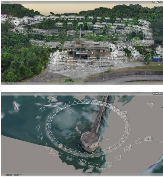
圖 4 環繞傾斜拍攝方法示意圖
