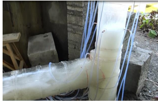
圖 5 小流量低尾水位工况消力井及支洞進口流態
